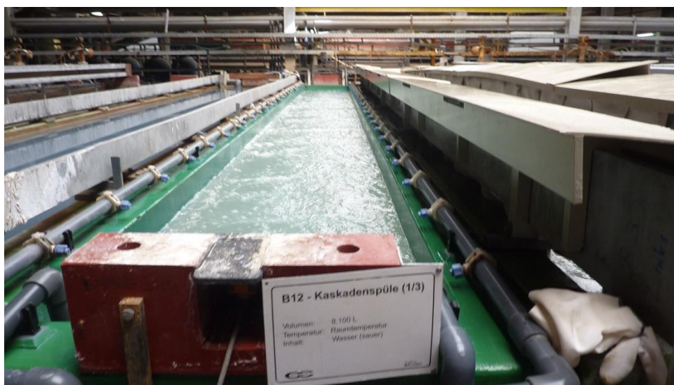
Foto 4: Tussen de processtappen wordt steeds gespoeld.
