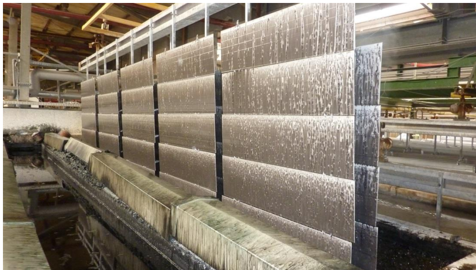
Foto 5: Gebeitst aluminium wordt uit het bad gehesen.
