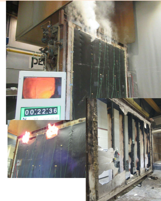
Waarneming tijdens test: Tijdens de test ontstond na 22 minuten een gat in de folie. Na 26 minuten traden vlammen > 10 seconden op, waarmee de prestatie E werd bereikt. Na afloop was vanaf de vuurzijde het houten frame zichtbaar.
